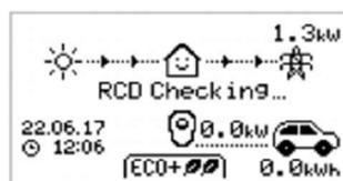
zappi führt eine Funktionsprüfung des eingebauten RCD-Schutzes durch, bevor mit dem Laden des Fahrzeugs begonnen wird. zappi führt diese Prüfung vor jedem Ladevorgang durch, so dass der RCD-Schutz nicht manuell getestet werden muss.
